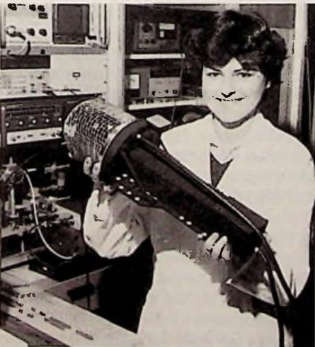
**Bild 9: Mikrowellen-Verstärkerröhre (260 W) für TV-Satelliten** (AEG-Pressbild)
