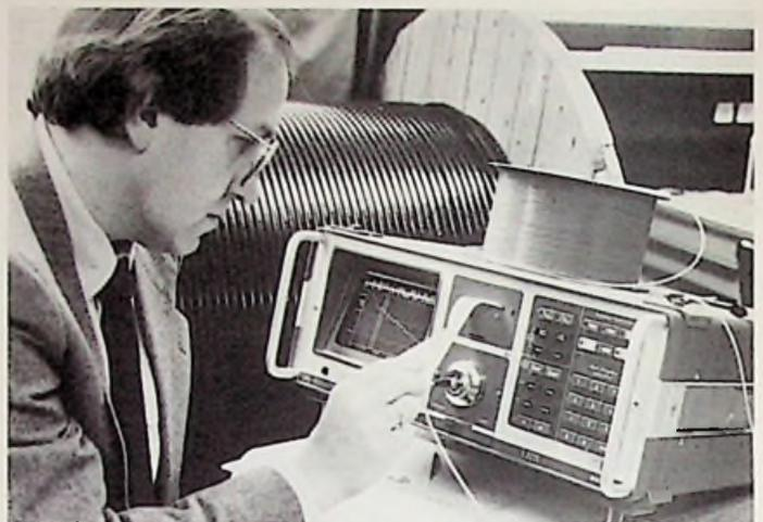
**Bild 1:** Universalmeßgerät mit hohem Meßkomfort für Lichtwellenleiter (Siemens-Pressebild)
